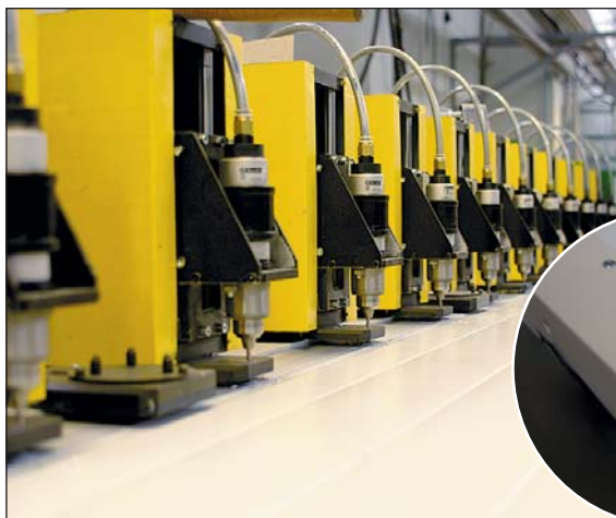
Automatické přivrtání montážního otvoru.
